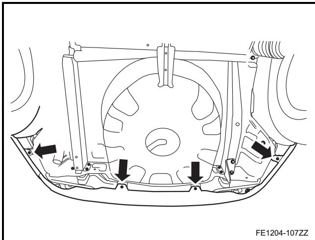
6) 举升车辆，安装后保险杠底部 4 个固定螺栓。降下车辆。
